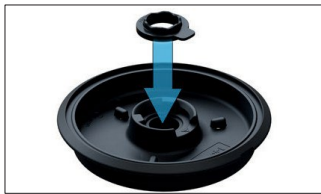
Fäst skrapingen i skyddspackningen.
